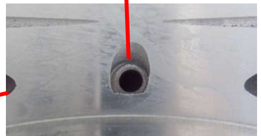
MANDATORY LINER LOCKING PIN GOUILLE OBLIGATOIRE DE BLOCAGE DE LA CHEMISE
