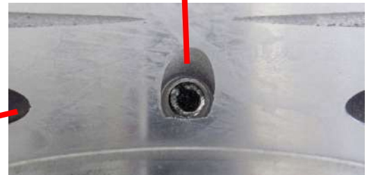
MANDATORY LINER LOCKING PIN GOUPILLE OBLIGATOIRE DE BLOCAGE DE LA CHEMISE
