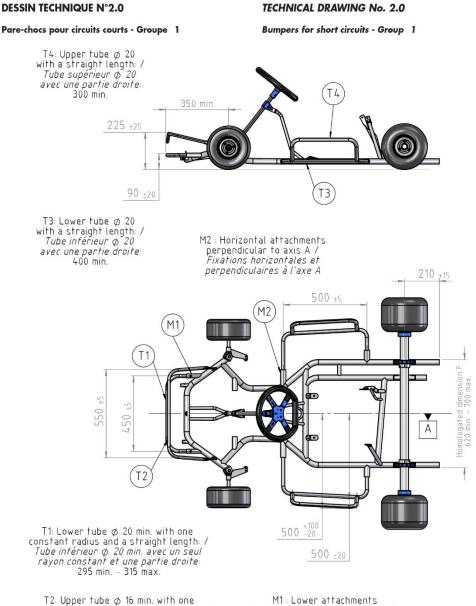
T2: Upper tube Ø 16 min. with one constant radius and a straight length: / Tube supérieur Ø 16 min. avec un seul rayon constant et une partie droite: 375 min. – 395 max.
