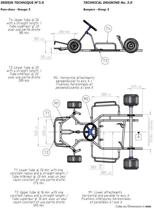
M1: Lower attachments horizontal and parallel to axis A Fixations inférieures horizontales et parallèles à l'axe A Cotes en/Dimensions in mm
