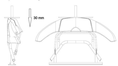
Plaque pour essais de poussée verticale - carénage avant
